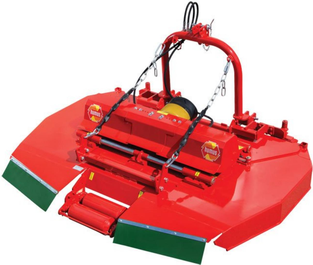
Die Sichelmäher der LV-Serie zeichnen sich durch eine äußerst kompakte und niedrige Bauweise aus. Sie sind nahe am Traktor montiert, was eine Gewichtsverteilung und einen kleinen Wenderadius begünstigt.
