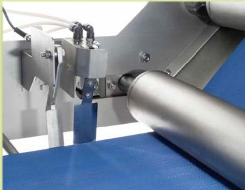
Vollautomatische Bandlaufsteuerung und Not-Aus bei Bandverlauf
