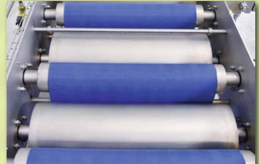
Gute Zugänglichkeit der zu reinigenden Maschinenteile
