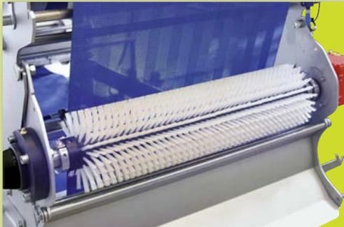
Einfach nachrüstbare, optionale Bürstenreinigung für die Entfernung von eingepressten Partikeln bei problematischen Presskuchen
